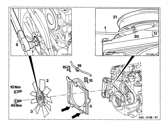
Viscous fan clutch (3) .....
